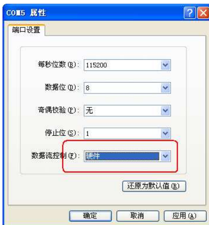
图 1.9 串口流控设置
